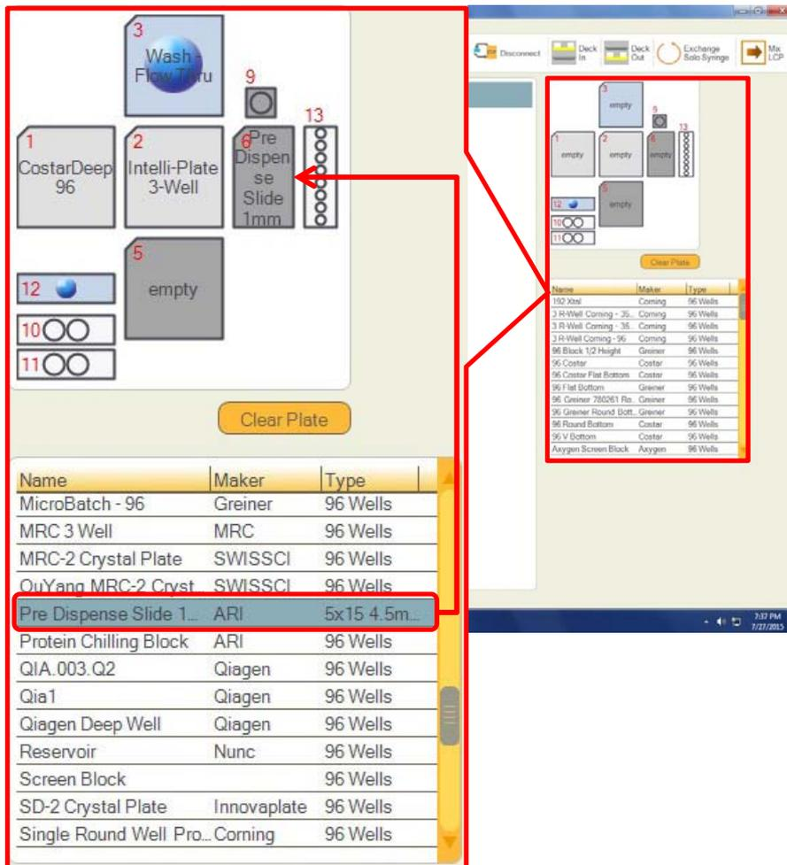
此处使用 LCP 点样为例进行说明，1 号板位放置 CostarDeep96(一种深孔板)，2 号板位使用 Intelli-Plate3-Well(一种坐滴板)
