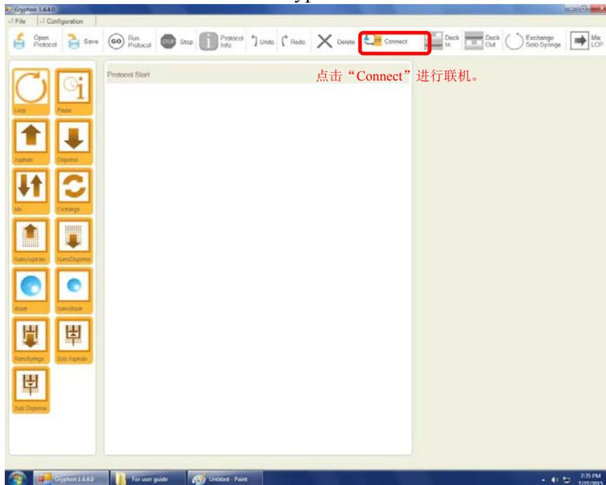
联机过程中, 会提示确认 LCP 加样针(Solo Syringe)活塞柄没有固定, 或 LCP 针没有安装, 否则可能导致 LCP 加样针中液体的流失。
