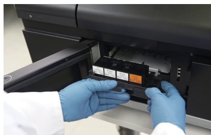
图 2. 用户可以轻松更换 Amersham Typhoon 5、RGB、NIR Plus 和 NIR 型号中的滤光片。如果插入新的滤光片或更换滤光片，仪器会自动识别滤光片并在控制软件中更新。
